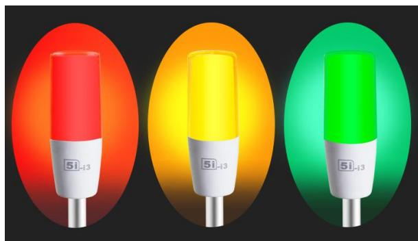
机床的三色状态指示灯用于告知现在机器处于什么状态，当机床属于待机时，指示灯显示黄色；当机床属于自动加工时，指示灯显示绿色；当机床出现报警或者其他警告时，指示灯显示红色并同时发生蜂鸣声。
