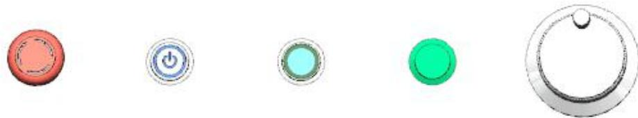
机床 NC 系统下面按钮由左到右的功能是：紧急停止；电源开关；电源指示灯；程序循环启动；电子手轮。当机器正常开机时，只需要按第二个按钮，指示灯亮，为开机状态，指示灯灭，为关机状态；急停停止是作用于电源，按下会切断所有机床主电路，紧急情况可按下，向右旋转复位急停开关；指示灯显示机器插座是否和电网已连接；绿色的循环启动开关是用于是启动 NC 程序，建议自动加工中用此按钮运行程序，因为 NC 面板上的启动按钮，长时间使用有可能导致失灵，进而发生不可预计的事情。
