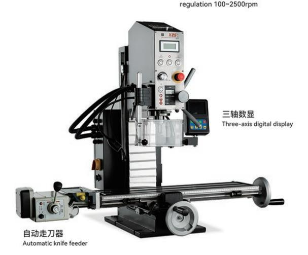
广泛用于工厂、维修店铺、学校、科创中心及科研单位教学演示使用,适合家用DIY,航模零件、钟表零件加工;可加工钛、不锈钢、45号钢、铁、铝、铜等各类有色金属和木材、尼龙等各类软材料。
