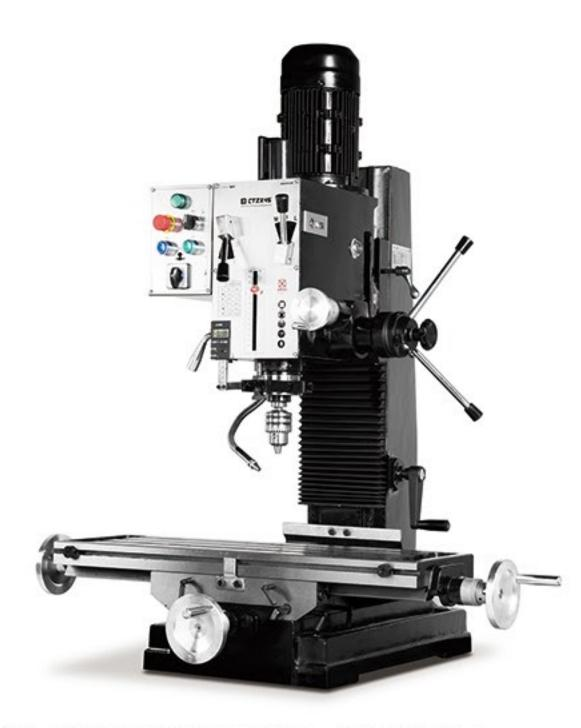
广泛用于工厂、维修店铺、学校、科创中心及科研单位教学演示使用,适合家用DIY, 航模零件、钟表零件加工; 可加工钛、不锈锅、45号锅、铁、铝、铜等各类有色金属和木材、尼龙等各类软材料。
