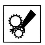
旋转部件 如果需要在机床上进行旋转部件维修工作时,应先断开机床电源,机床的旋转部件可能会造成严重或致命的人身伤害。
